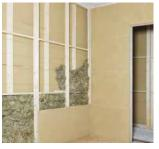
Panneau d'argile pour l'habillage des ossatures en bois ou métal des cloisons intérieures, parements, surfaces de plafonds et de sous-pentes. Le panneau d'argile lourd offre un apport d'argile important pour l'habitat, y compris tous les effets positifs sur le climat ambiant, notamment sur le plan thermique. Pour la découpe, il convient d'utiliser une scie circulaire. Le panneau d'argile D 22 offre une trame large de 62,5 cm pour l'ossature porteuse des panneaux.
