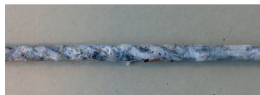
Dualfix Durable anker na 500 uur zoutsproeitest
