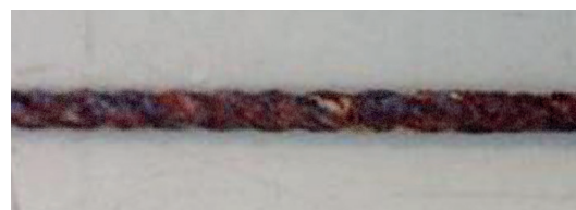
Traditioneel verzinkt anker na 500 uur zoutsproeitest
